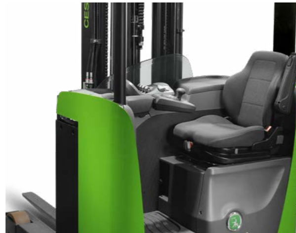
Cabine conçue autour du conducteur (montre le siège « confort » en option).
