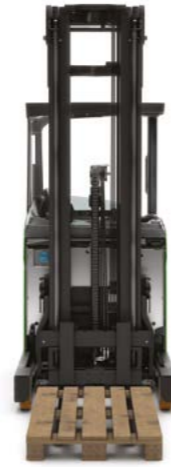
Le châssis étroit du CESAB R200 facilite la manutention des palettes EUR entre les bras de support.
