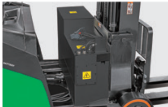
Sortie de la batterie
