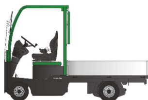
PE 15.1 Capacité de charge 1.5 t Traction 10 t
